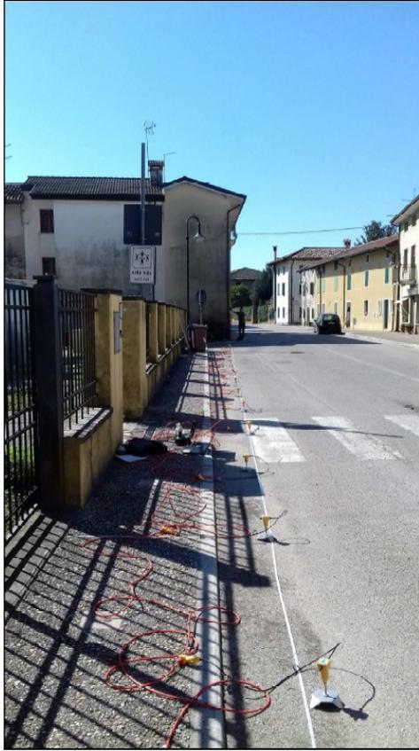
Foto n°1 – Stesa sismica M.A.S.W.
